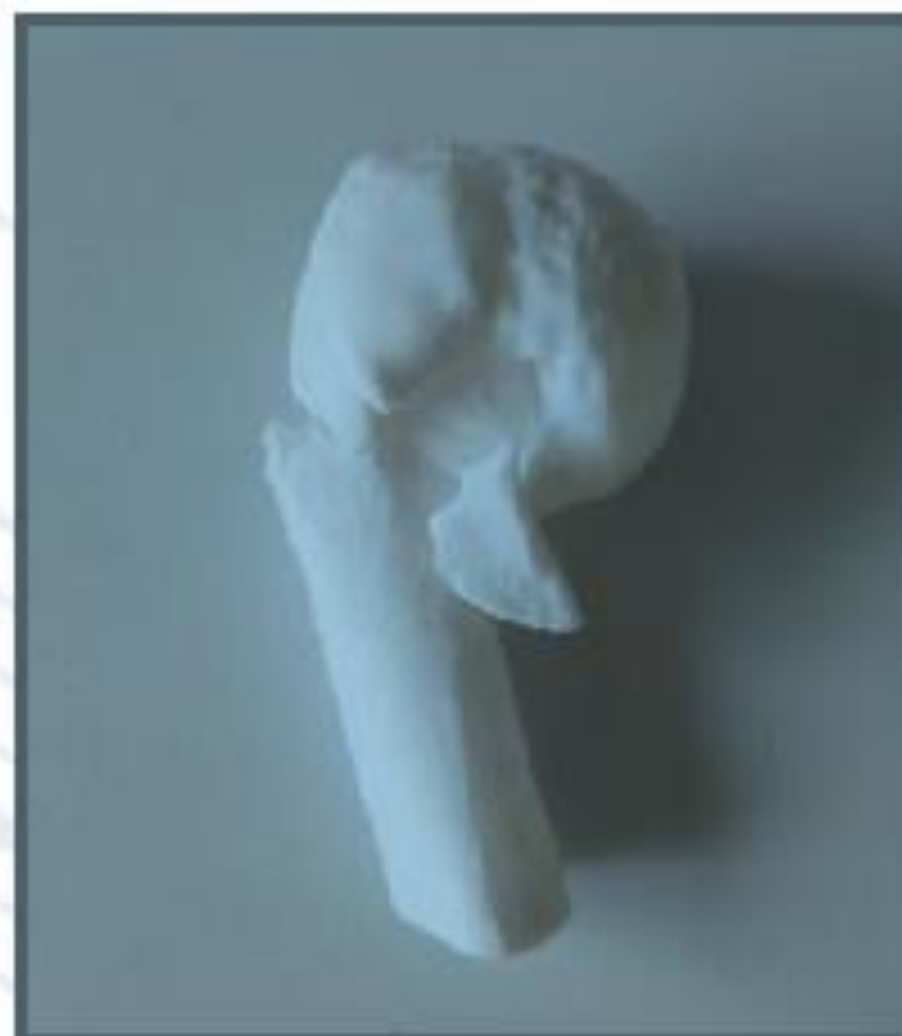
Fig 1: Fractura de húmero proximal impresa en PLA de 1.75mm escala 1:1
